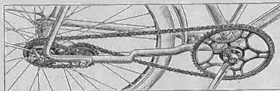
Le moyeu de la roue arrière porte deux pignons à roue libre. La chaîne qui vient du pédalier enveloppe l'un de ces pignons et son brin inférieur passe sur un pignon intermédiaire, monté sur un axe parallèle au moyeu et fixé sur la fourche arrière.
