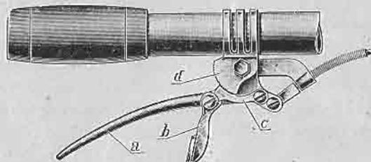
Ce levier fonctionne comme le levier simple. Mais si l'on veut bloquer la machine ou arrêter le levier dans une position quelconque pendant une longue descente, il suffit de pousser légèrement vers le haut le petit levier *b*. Celui-ci étant excentré sur la vis autour de laquelle il pivote, vient pousser la pièce *c* contre la pièce *d* et maintient le serrage voulu.
