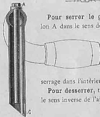
Pour serrer le guidon, tourner le boulon A dans le sens de l'aiguille d'une montre.
