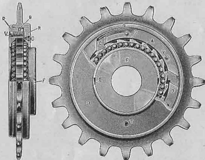
**Démontage.** — Dévissez les vis de pression V, desserrez la rondelle R.
