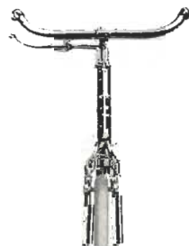
Frein "Terrot" n° 2 sur fourche avant - Breveté S.G.D.G. Primé au Concours du T. C. F.
