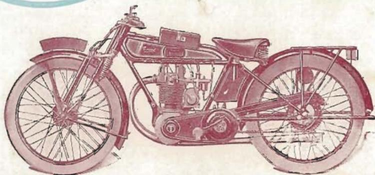
**TYPE MSS. — 3 CV SUPERSPORT. —** MOTEUR "Terrot-Jap" 4 temps à culbuteurs 62,5x80. — GRAISSAGE mécanique avec vitreur et pompe de secours. — BOITE "Terrot" 5 vitesses. — DÉBRAYAGE à disques multiples. — MISE EN MARCHÉ. — TRANSMISSION chaîne et chaîne. — FREINS avant et arrière dans les moyeux. — FOURCHE à quadrilatogramme avec amortisseurs. — FREIN de direction. — PNEUS 650x65. — REPOSE-PIEDS accroté. — GUIDON TT réglable. — SELLE "Terry".
