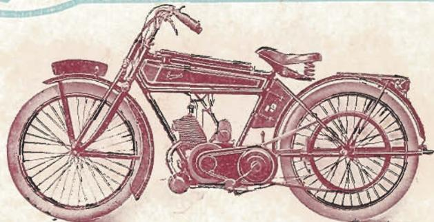
**TYPE L. — 2 CV TOURISME.** — MOTEUR "Terrot" 2 temps 57x68. — BOITE "Terrot" 2 vitesses. — DÉBRAYAGE et mise en marche. — TRANSMISSION chaîne et courroie. — FOURCHE élastique "Terrot". — PNEUS 600x55. — REPOSE-PIEDS caoutchouc. — GUIDON relevé.
