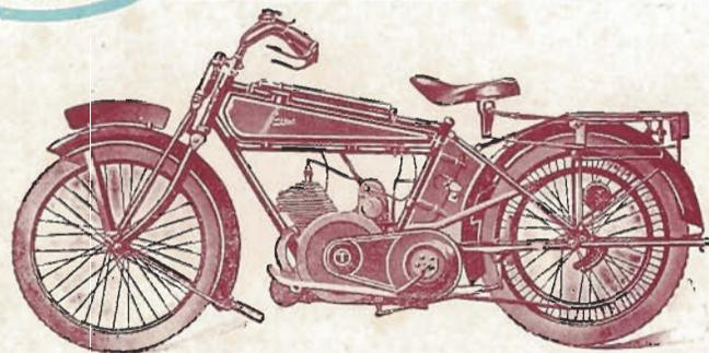
**TYPE FT. — 3 CV TOURISME.** — MOTEUR "Terrot" 2 temps 67x70. — BOITE "Terrot" 3 vitesses. — DÉBRAYAGE à disques multiples. — MISE EN MARCHÉ. — TRANSMISSION chaîne et courroie. — FOURCHE élastique "Terrot". — PNEUS 600x65. — MARCHÉ-PIEDS wagon. — GUIDON relevé. — SELLE N° 5.
