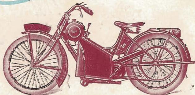
**TYPE LD. — 2 CV DAME.** — MOTEUR "Terrot" 2 temps 57x68. — BOITE "Terrot" 2 vitesses. — DÉBRAYAGE et mise en marche. — TRANSMISSION chaîne et courroie. — FOURCHE élastique "Terrot". — PNEUS 600x55. — MARCHÉ-PIEDS wagon. — GUIDON relevé. — CAPOT pare-jambes complet, démontage instantané sans le secours d'aucun outil. — CACHE-COURROIE.
