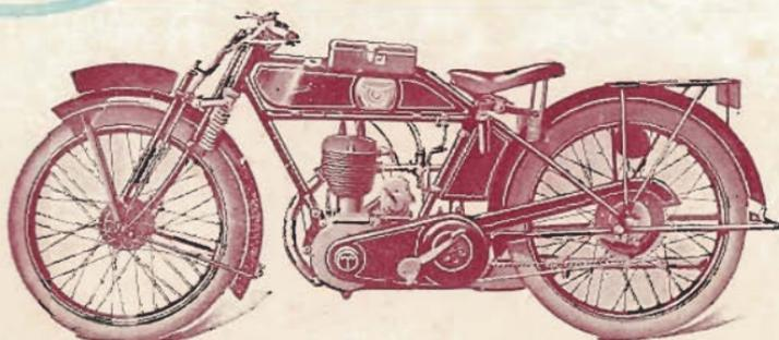
**TYPE HT. — 4 CV TOURISME.** — MOTEUR 4 temps 70 X 90 soupapes latérales. — GRAISSAGE par pompe à main. — BOITE "Terrot" 3 vitesses. — DÉBRAYAGE à disques multiples. — MISE EN MARCHÉ. — TRANSMISSION chaîne et chaîne. — FREINS avant et arrière dans les moyeux. — FOURCHE élastique. — PNEUS 650 X 65. — MARCHÉ-PIEDS wagen. — GUIDON relevé. — SELLE HG n° 5.
