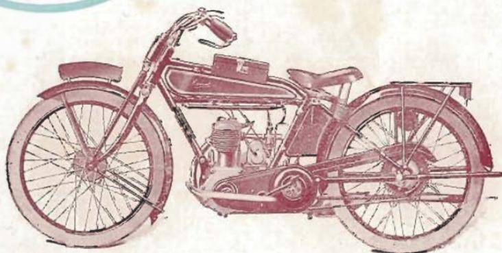
**TYPE M 2. — 3 CV LUXE. —** MOTEUR "Terrot-Jap" 4 temps 64,5x76. — GRAISSAGE mécanique avec indicateur. — BOITE "Terrot" 2 vitesses. — DÉBRAYAGE à disques multiples. — MISE EN MARCHÉ. — TRANSMISSION chaîne et chaîne. — FREINS avant et arrière dans les moyeux. — FOURCHE élastique. — PNEUS 650x65. — MARCHÉ-PIEDS wagon. — GUIDON relevé. — SELLE n° 5.
