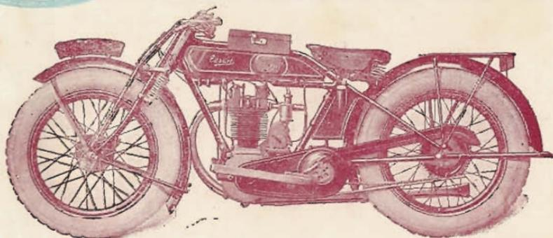
**TYPE HSS. — 4 CV SUPERSPORT.** — MOTEUR 4 temps à culbuteurs 70 X 90. — GRAISSAGE par pompe mécanique avec viseur et pompe de secours. — BOITE "Terrot" 3 vitesses. — DÉBRAYAGE à disques multiples. — MISE EN MARCHÉ — TRANSMISSION chaîne et chaîne. — FREINS avant et arrière dans les moyeux — FOURCHE à parallélogramme avec amortisseurs. — FREIN de direction. — PNEUS 650 X 65 — REPOSE-PIEDS caoutchouc. — GUIDON TT réglable. — SELLE "Terry".
