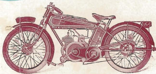
**TYPE FSS. — 3 CV SPORT.** — MOTEUR "Terrot" 2 temps 67x70 à double échappement. — BOITE "Terrot" 3 vitesses. — DÉBRAYAGE à disques multiples. — MISE EN MARCHÉ. — TRANSMISSION chaîne et chaîne. — FREINS avant et arrière dans les moyeux. — FOURCHE élastique. — PNEUS 650x66. — REPOSE-PIEDS caoutchouc. — GUIDON TT réglable. — SELLE "Terry".
