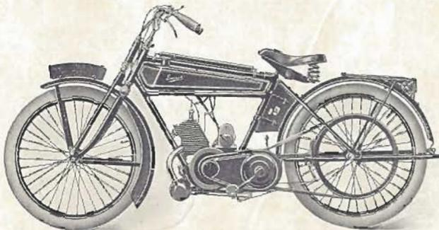
**Moteur "Terrot"** à 2 temps et distribution automatique par 3 lumières. Aspiration et précompression dans le carter. Alésage 57 <sup>mm</sup>/<sub>16</sub>. Course 68 <sup>mm</sup>/<sub>16</sub>. Cylindrée 175 cc.
