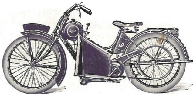
**TYPE LD. — 2 CV DAME.** — Moteur "Terrot" 2 temps 57×68. — Boîte "Terrot" 6 vitesses. — Débrayage et mise en marche. — Transmission chaîne et courroie. — Fourche élastique "Terrot". — Pneus 600×55. — Marchepieds wagon. — Guidon relevé. — Capot pare-jambes complet, démontage instantané sans le secours d'aucun outil. — Cache-Courroie.
