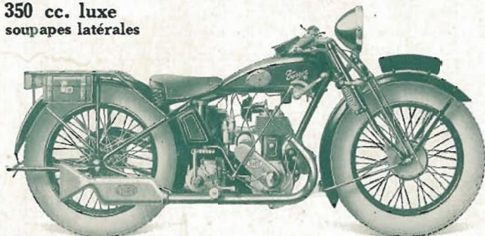
Moteur 4 temps 70×90 à soupapes latérales. — Graissage de la tête de bielle par pompe mécanique. — Boîte 3 vitesses à carter renversé et 4 attaches. — Cadre semi-berceau. — Fourche élastique de 160<sup>mm</sup> de passage. — Garde-boue de 160<sup>mm</sup>. — Pneus de 27×4 (700×100). — Guidon semi-relevé et Marchepieds wagon (type HOT) ou Guidon sport et Repose-pieds caoutchouc (type HOS).
