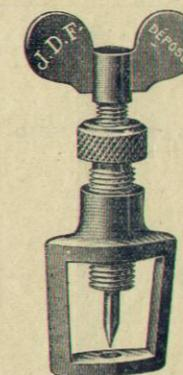
N° 1219 - Nouveau modèle réglable, permettant le serrage de la courroie et par conséquent le perçage de toutes courroies trapézoïdales de 12 à 30 mm d'épaisseur.
