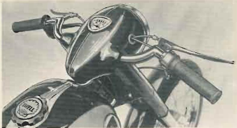
Guidon sport permettant une position effacée sur selle double sport. Fourche télescopique avec amortisseurs hydrauliques à double effet.
