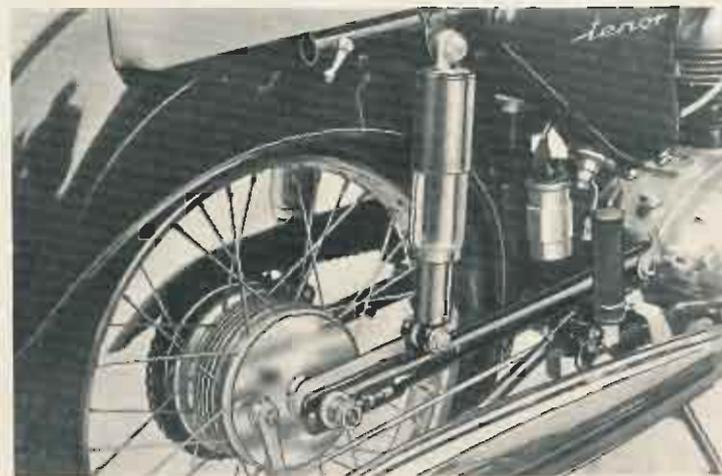
**CONFORT** et tenue de route incomparables, fourche oscillante et amortisseurs hydrauliques à double effet.
