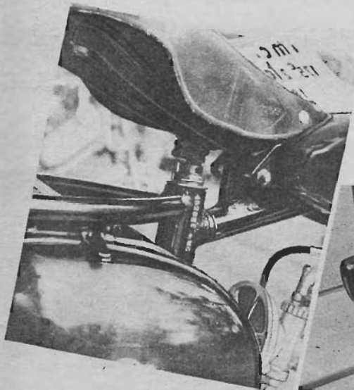
Ci-dessus, la suspension de selle. A droite, une vue côté volant magnétique.
